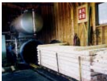
(写真5-10) 防腐注入
