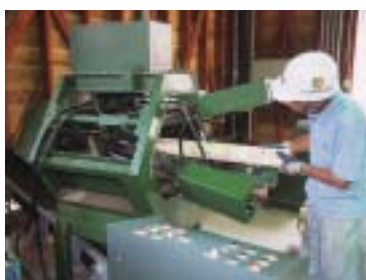
(写真3-5) 杭先削り機
