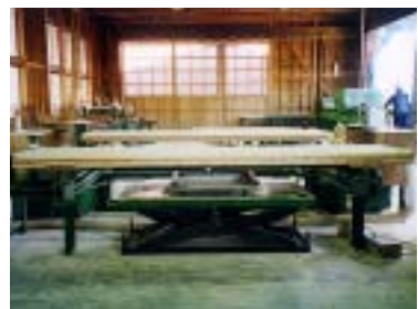
(写真5-9) 組立・両端切削加工
