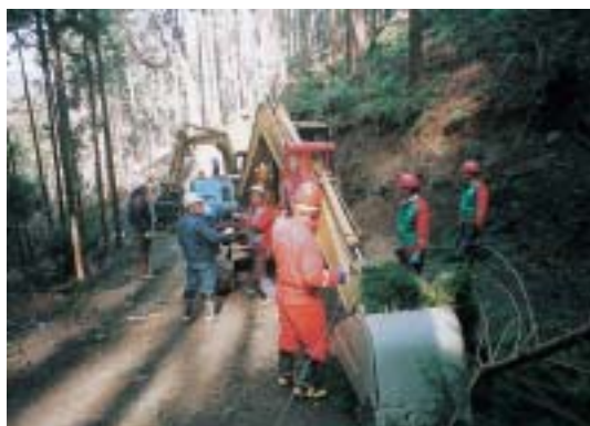
▲移動可能な集材機(タワーヤード)の取り扱い実習状況
