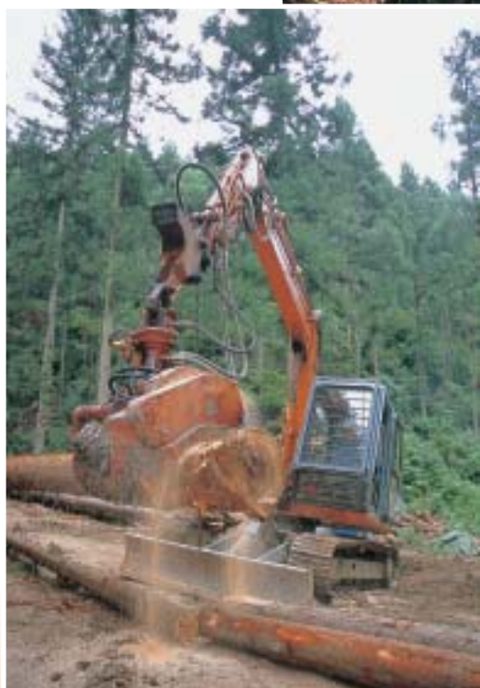
プロセッサーによる造材作業中
